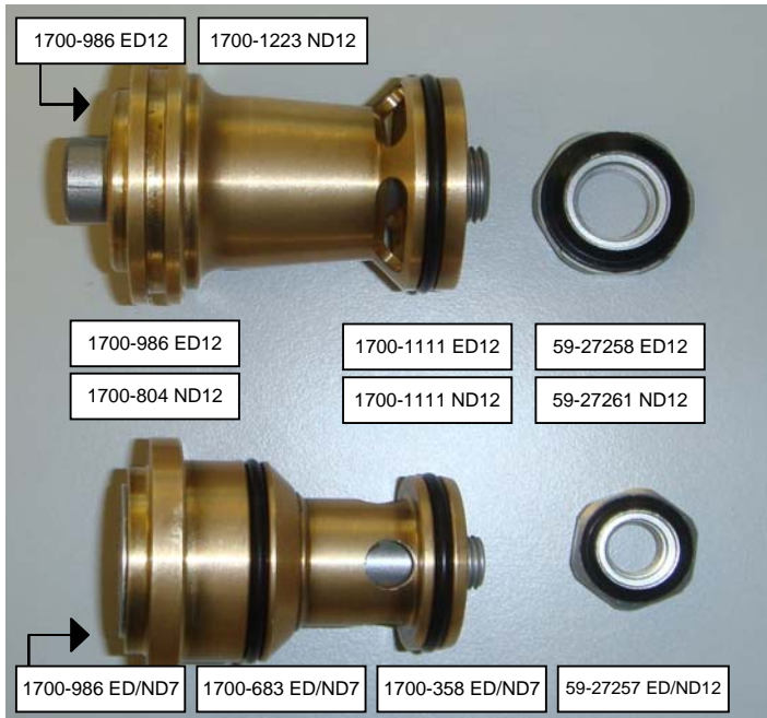
Oben: ED12-Patrone und Ventilsitz Unten: ED07-Patrone und Ventilsitz
